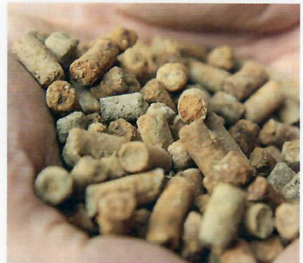
Auch Pellets auf Basis von Eisenhydroxid können Schwefel aufnehmen.
